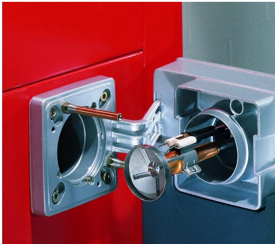
Palnik w pozycji serwisowej: Łatwy dostęp do urządzenia mieszającego
